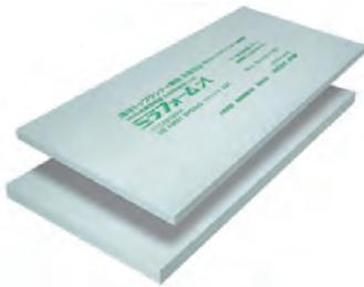
これまで培ってきたプラスチック発泡技術により、熱伝導率は 0.022W/(m・K)。独自の気泡膜により輻射熱を抑制しガスバリア性をアップしたことに加え、気泡形状による熱伝導率の抑制効果で高い断熱性能を持つ。また、曲げ強さ(靱性)は 20N/cm<sup>2</sup>以上、圧縮強さは 10N/cm<sup>2</sup>以上、吸水量は 0.01g/100cm<sup>3</sup>以下と、さまざまな高い性能を持つ。ノンフロン、ノンホルムアルデヒドなど人や環境にもやさしい。
