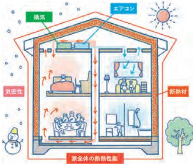
エアロジックは、適切な断熱性能を確保した上でその家の性能や住まい方に合った設備を選び、必要最低限のエネルギー（電気代）で暑さ&寒さのない暮らしを実現させよう、という考えから生まれた全館空調システム。断熱性能の提案から、空調計画・施工、アフターフォローに至るまで、全館空調導入に必要なプロセスをサポートする。サポートを通じて住まい手を寒暖ストレスから解放し、健康的な生活へと導く。
