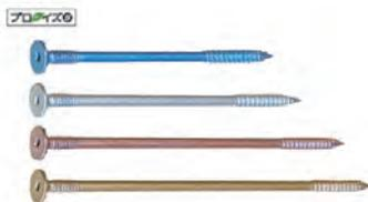
Zマークひねり金物（ST-12）の2倍以上の耐力を有するビス。引き寄せ効果を持たせたネジ形状により屋根が吹き飛ばされないように、たる木と母屋・軒桁・棟木を強固に接合する。屋根倍率は1.4～2.2倍（条件により異なる）で、小屋組みの水平方向の変形を防止し、火打ち梁を設けず、すっきりとした勾配天井の吹き抜けをつくることもできる。
