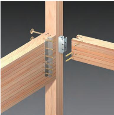
コンパクトなワンピース型で、小型軽量化を実現した金物工法。接合部の木材断面の欠損を最小限に抑え構造体の強度を向上する。金物を2種類または3種類組合せることで1200mmまでの大きな梁成にも対応できるため、木造住宅から中大規模木造建築まで様々な用途で使用できる。燃えしろ設計の参考資料もホームページで公開。
