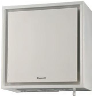
壁にパイプ取り付けの簡単施工。天井裏などのダクト施工が不要なため、ダクト式では設置が難しかった住宅への導入が可能になった。また、給排気ファン内蔵で強制同時給排気できる方式を採用。さらに温湿度を回収し、冷暖房コストを抑える全熱交換型の熱交換素子内蔵。ZEH住宅の申請における1次エネルギー消費量の計算では、「熱交換型換気設備」として入力できる。
